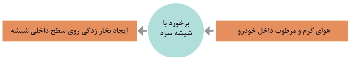
شکل ۳۲- فرایند بخار زدگی شیشه‌ها
