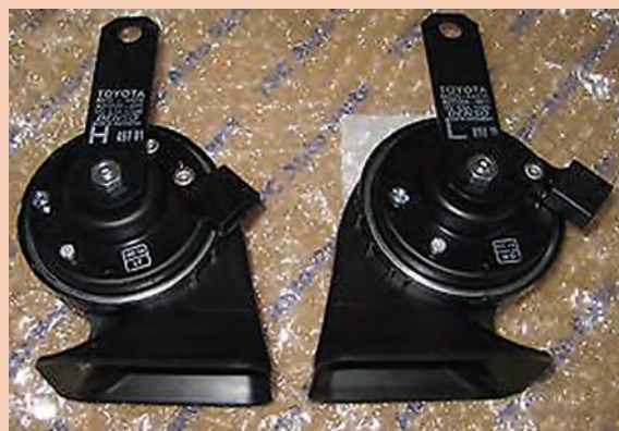
شکل ۴۸- درج L و H روی دستگاه بوق
