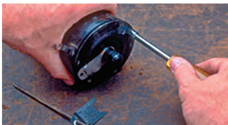
- باز کردن پیچ‌های اتصال درپوش به بدنه استارت
