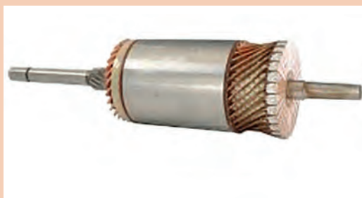
شکل ۸۳- دو نوع آرمیچر موتور استارتر
