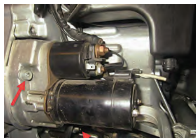
باز کردن پیچ‌های اتصال استارت به موتور
