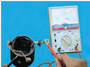
– آزمایش اتصال بدنه بالشتک ها
