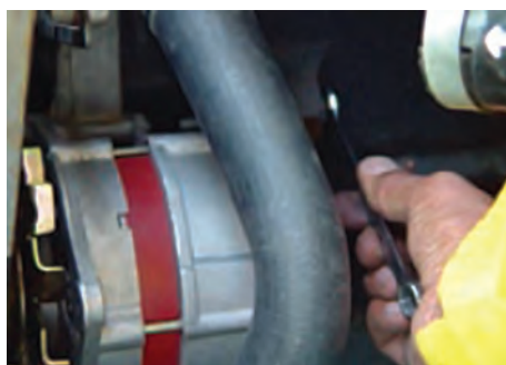
بازکردن پیچ‌های پایه آلترناتور
