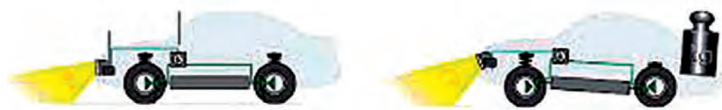
شکل ۹- دلیل نیاز به سیستم تنظیم ارتفاع چراغ
