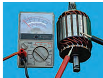
– آزمایش اتصال بدنه آرمیچر
