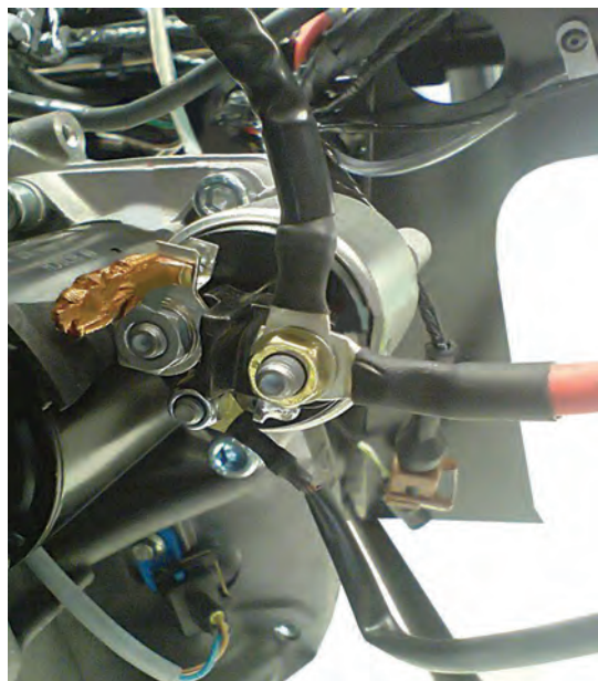
شکل ۸۹ - بررسی استحکام اتصالات پیچ و مهره ای مجموعه استارت تر
