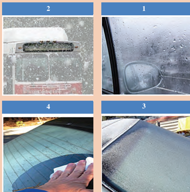
شکل ۳۱- بخار گرفتگی روی شیشه‌ها
