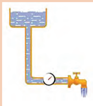
شکل ۵- شبیه سازی خواص الکتریکی با جریان آب
