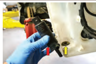
شکل ۳۰- مراحل تعویض پمپ شیشه شوی
