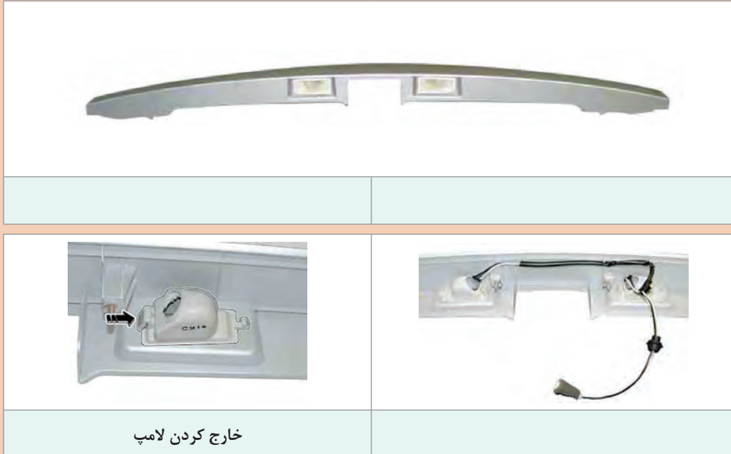
شکل ۳۵- روش باز کردن و بستن چراغ پلاک
