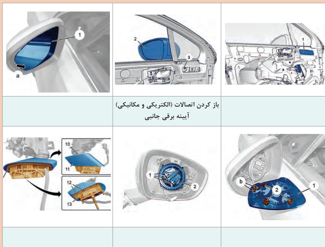
شکل ۲۰- نکات مهم باز کردن، بررسی و بستن مجموعه آینه جانبی الکتریکی
