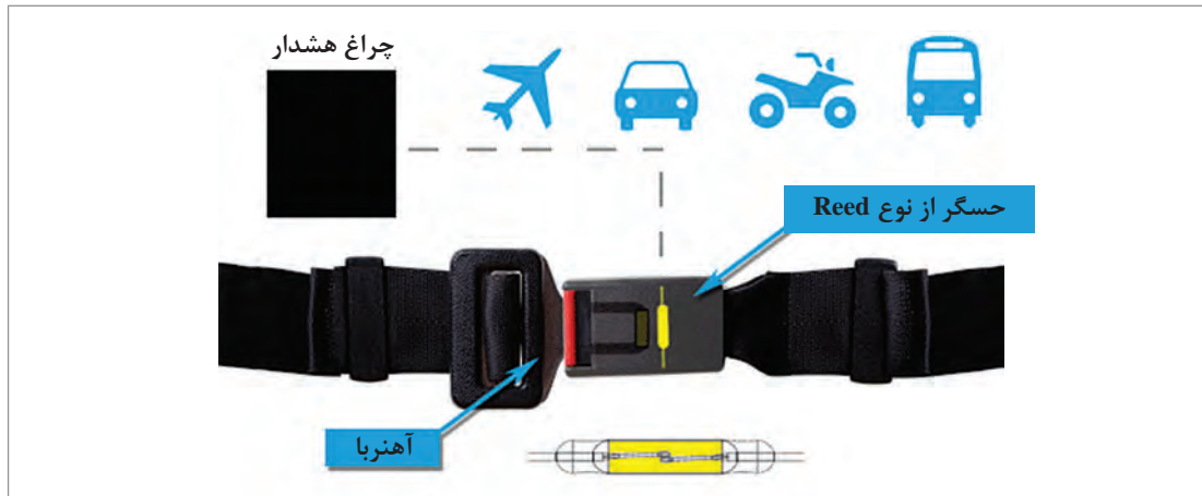
شکل ۲۳- عملکرد reed switch در کمربند ایمنی
