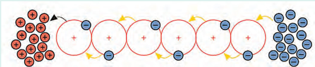
شکل ۱- حرکت الکترون‌ها در یک رسانا
