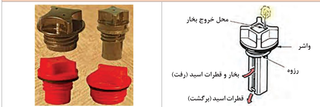
شکل ۴۲- چشمی و روش عملکرد آن (در باتری MF)
