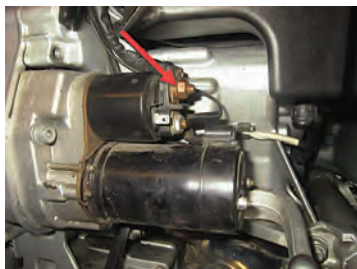
باز کردن مهره ترمینال B و کابل ترمینال مثبت باتری
