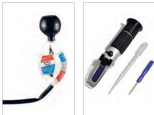
شکل ۴۷- روش بررسی الکترولیت در باتری
