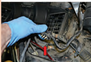
۷- اتصال اهرم‌بندی به بدنه را تمیز باز کنید.
